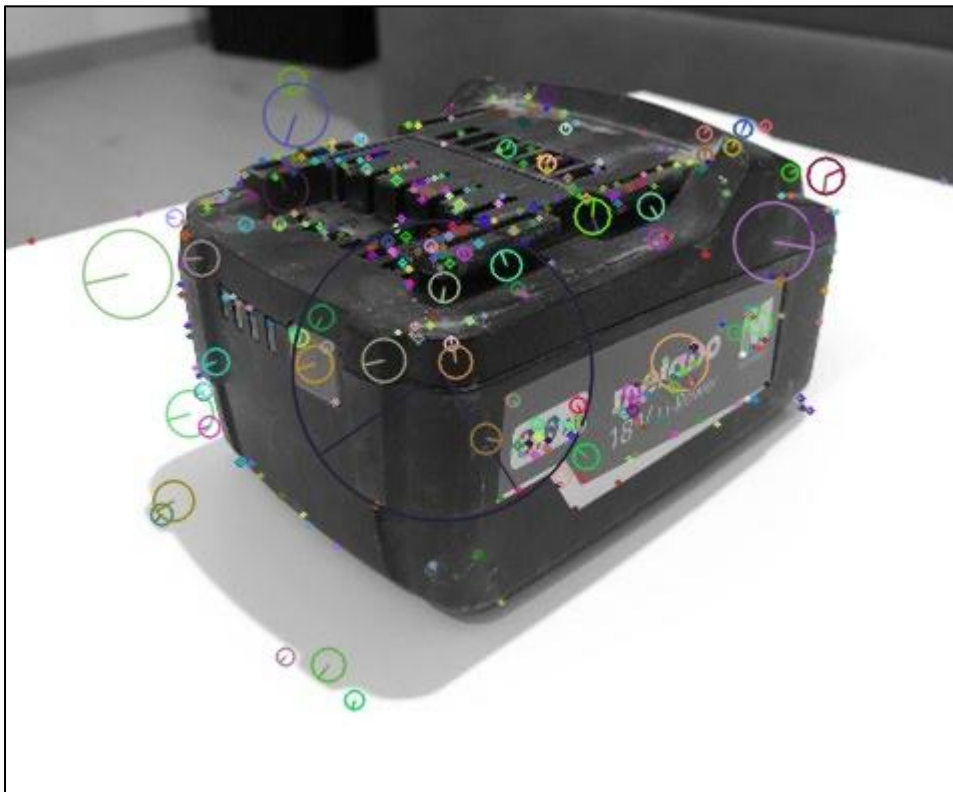
Abbildung 28: Akku nach Anwendung des SIFT-Algorithmus generiert durch „OpenCV“
