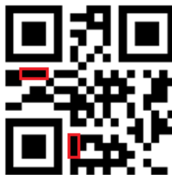
Abbildung 35: QR-Code, Ermittlung des Mask Pattern
