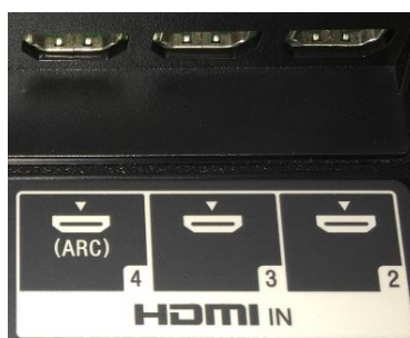
Abb. 89 – HDMI Eingänge 2-4, Eingang 4 mit ARC-Funktion
