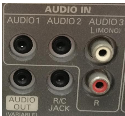
Abb. 75 – Analoge Audioeingänge und -ausgänge
