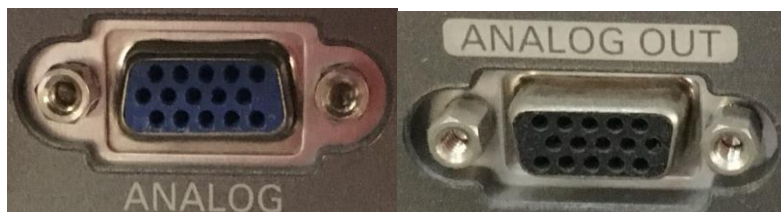
Abb. 73 – VGA-Eingang (links) & VGA-Ausgang (rechts)
