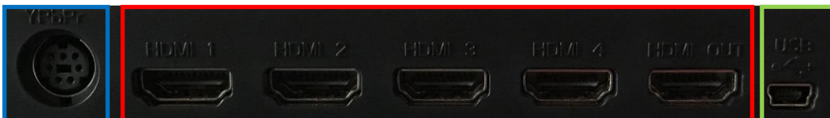
Abb. 101 – HDMI-Sender Anschlüsse (Komponenten-Video [blau], HDMI [rot], USB [grün])
