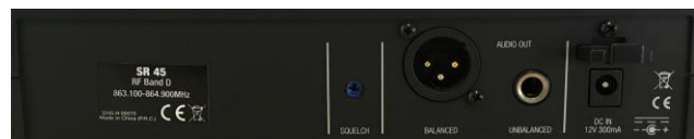
Abb. 50 – AKG SR45 Empfängerinheit Anschlüsse
