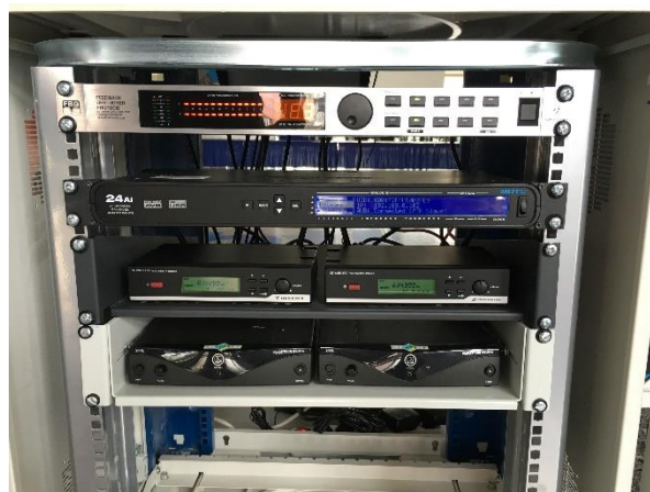
Abb. 115 - Regiewagen Serverrack (von oben nach unten: Feedback Destroyer, Soundkarte 24Ai, Sennheiser-Mikrofonempfänger, AKG-Mikrofonempfänger)
