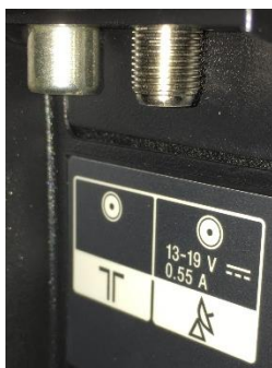
Abb. 92 – HF- bzw. Koaxialanschluss
