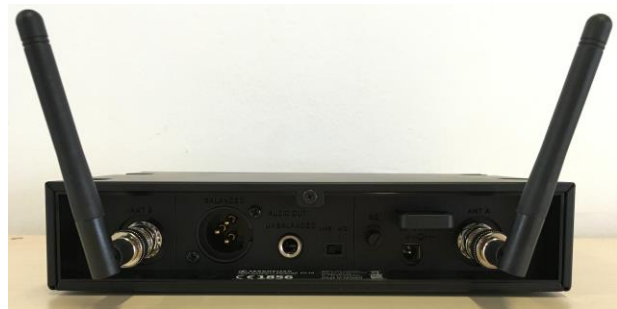
Abb. 48 – Sennheiser XSW-65 Empfängerinheit Anschlüsse
