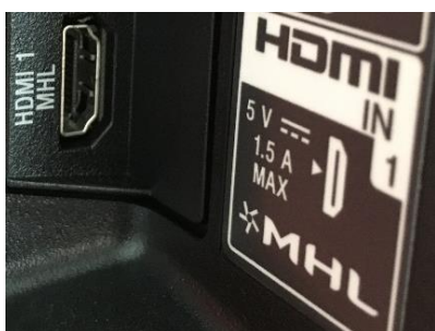
Abb. 88 – HDMI Eingang 1 mit MHL Funktion
