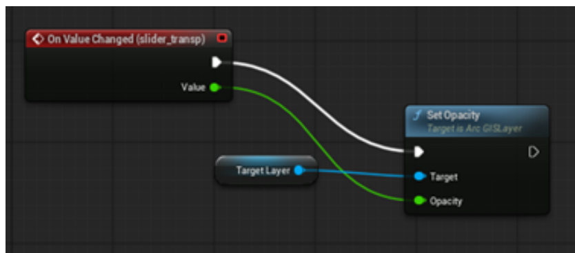
Abbildung 8: Blueprint-Logik: Stufenlose Transparenzsteuerung über Slider und Set Opacity
