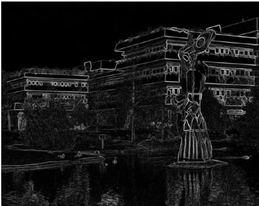
Abbildung 47 Bild mit erkannten Kanten
